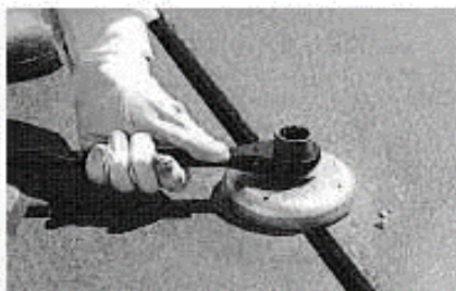
(6)再度、センターボルトの本締めを行います。
