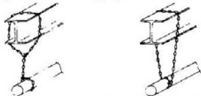
【図-2】1本掛(吊り荷重2.35KN) 【図-3】2本掛(吊り荷重4.21KN)
