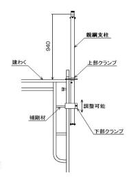
【 下部クランプ調整範囲 】 建枠上端より補剛材間隔 600mmまで
